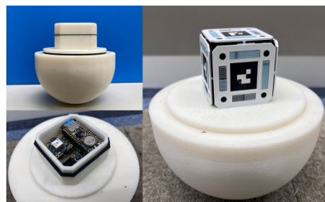
製作した模型ブイと内部に搭載されたセンサー
