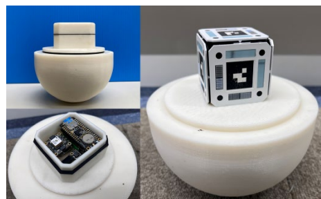
製作した模型ブイと 内部に搭載されたセンサー
