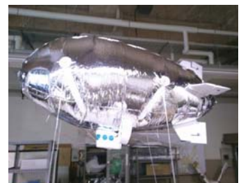
図 世界最小の内圧調整機構を搭載した飛行船
