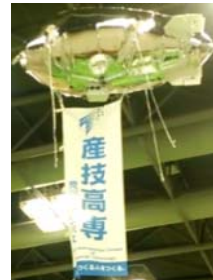
図 世界最小の内圧調整機構を搭載した飛行船
