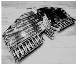
図 試作飛行した、日本初、世界最小のインフレータブル飛行機
